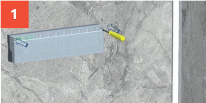
Utilice un destornillador para disclipar la cubierta de carcasa en los dos puntos de anclaje y sáquela.
